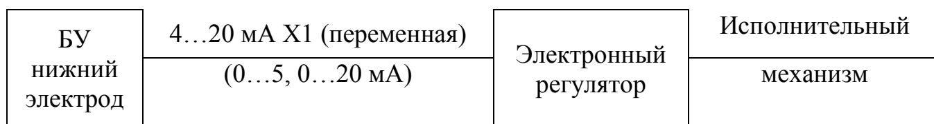
Рис. 2. Автоматическое регулирование уровня раздела фаз «нефть-вода» на базе электронного регулятора.
